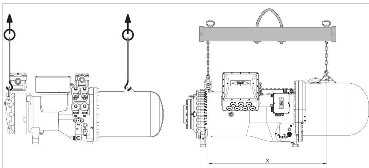
Рис. 1: Подъём компрессора. Слева CS.6 ... CS.8., справа CS.9. и CS.105
