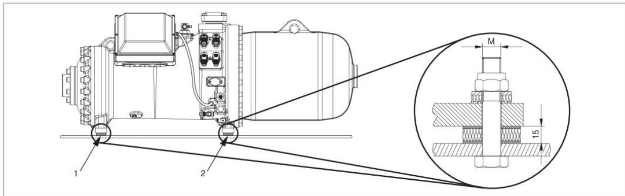
Рис. 4 Смонтированные виброопоры
