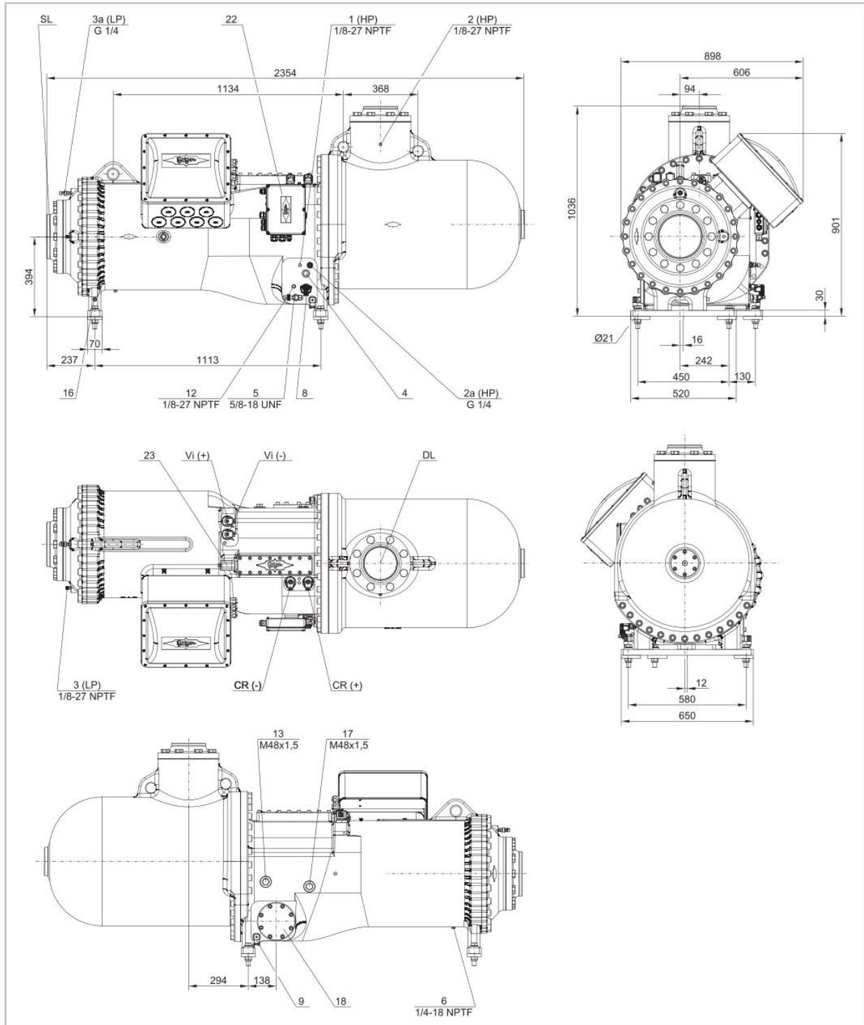
Рис. 16: Чертежи с указанием размеров для CS.105
