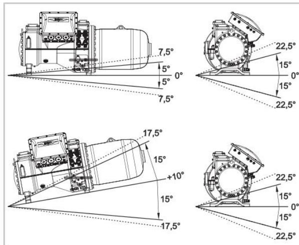
Рис. 3: Разрешенные углы наклона судна на примере CSH85
