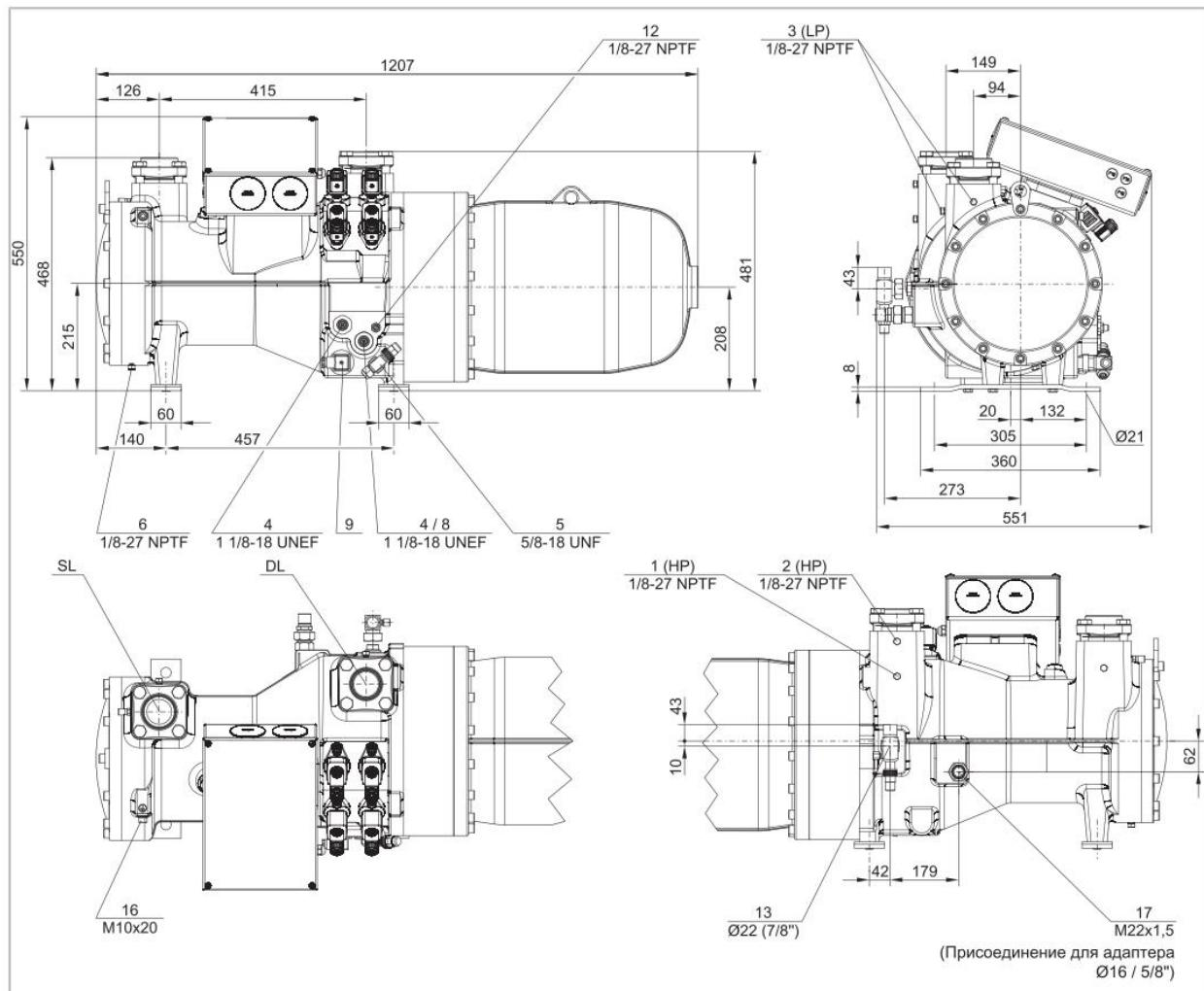
Рис. 12: Чертежи с указанием размеров для CSW6583-40Y .. CSW6593-60(Y)
