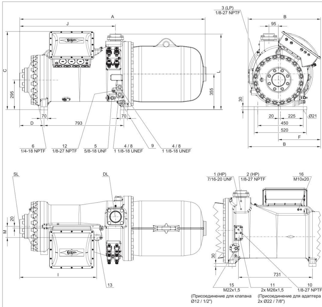
Рис. 11: Чертежи с указанием размеров для CSH9553-180(Y) .. CSH95113-320Y
