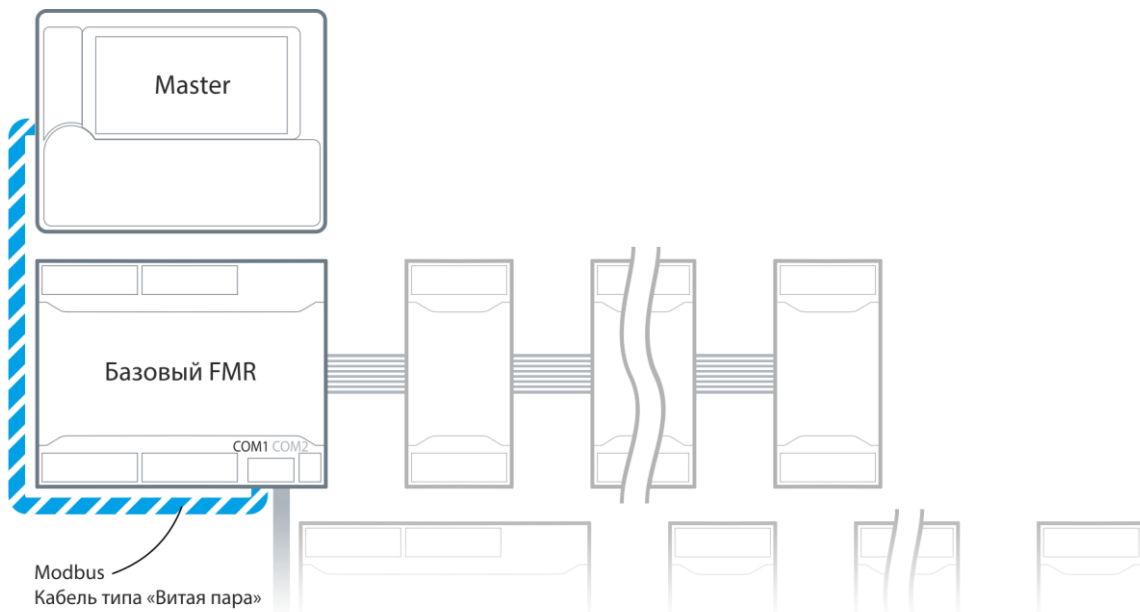
Рис. 26 - Подключение модуля FMR к контроллеру
