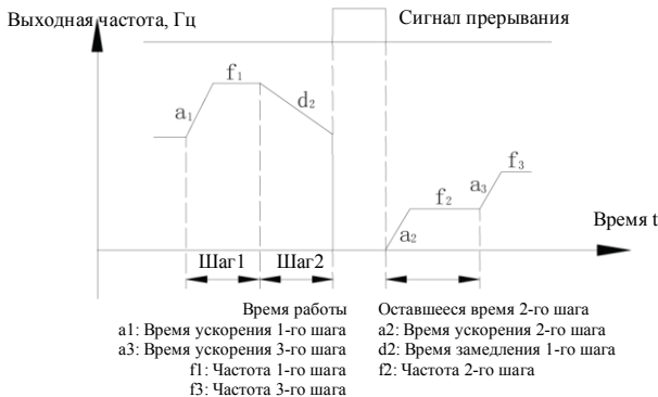
Рис.7-34 Режим перезапуска простого ПЛК 1
