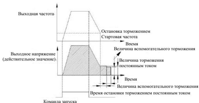
Рис. 7-5 Остановка с замедлением + Торможение постоянным током
