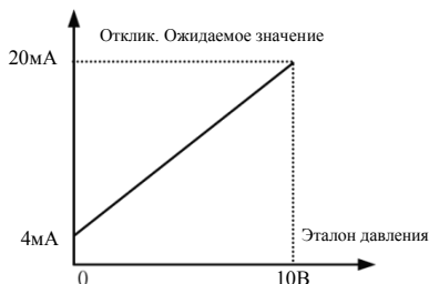
Рис.7-38 Значения эталона и ожидаемого отклика
