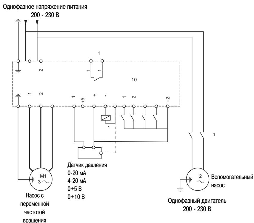
(1) Контакты реле неисправности, для дистанционного мониторинга состояния преобразователя частоты
