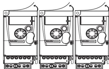
При установке преобразователей частоты вплотную защитные наклейки должны быть удалены. Способ В установки применяется, если температура воздуха рядом с преобразователем частоты не превышает  $55^{\circ}\text{C}$ .
