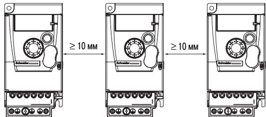
С установленными защитными наклейками с обеих сторон преобразователя частоты должно оставаться свободное пространство  $\geq 10$  мм. Способ А установки применяется, если температура воздуха рядом с преобразователем частоты не превышает  $55^{\circ}\text{C}$ . При температуре выше  $55^{\circ}\text{C}$ , защитные наклейки должны быть удалены.
