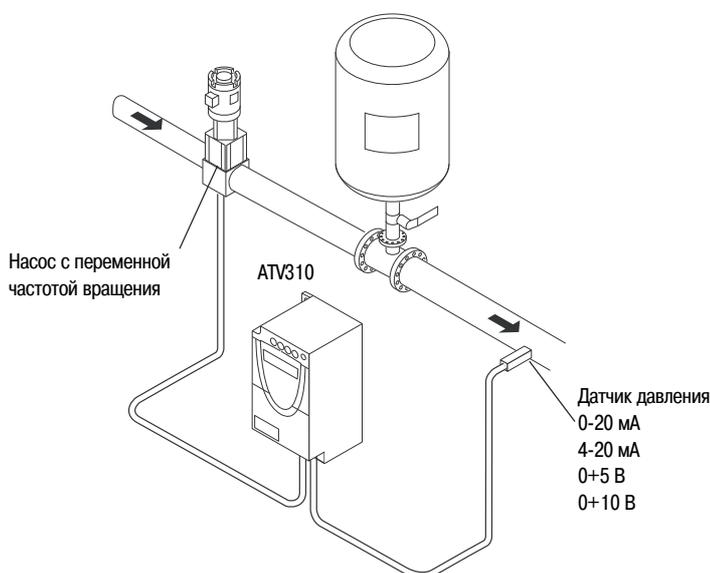
Вводятся значения с заводской таблички двигателя как значения соответствующих параметров в Меню **ПРИВОД 300-**
