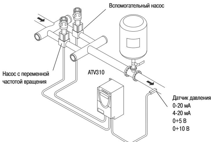
Вспомогательный насос управляется преобразователем частоты Altivar 310 посредством дискретного выхода LO
