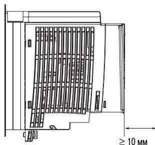
Установите преобразователь частоты вертикально, допускается отклонение от вертикальной оси  $\pm 10^\circ$
