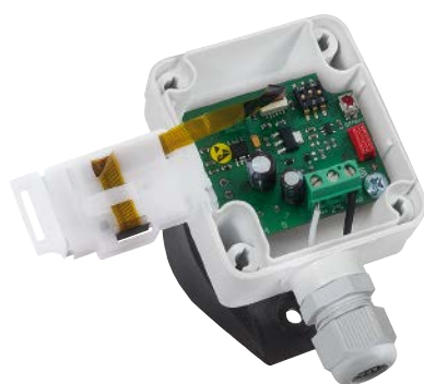
TM 65 с дисплеем и быстрозаворачиваемыми винтами (IP 67)
