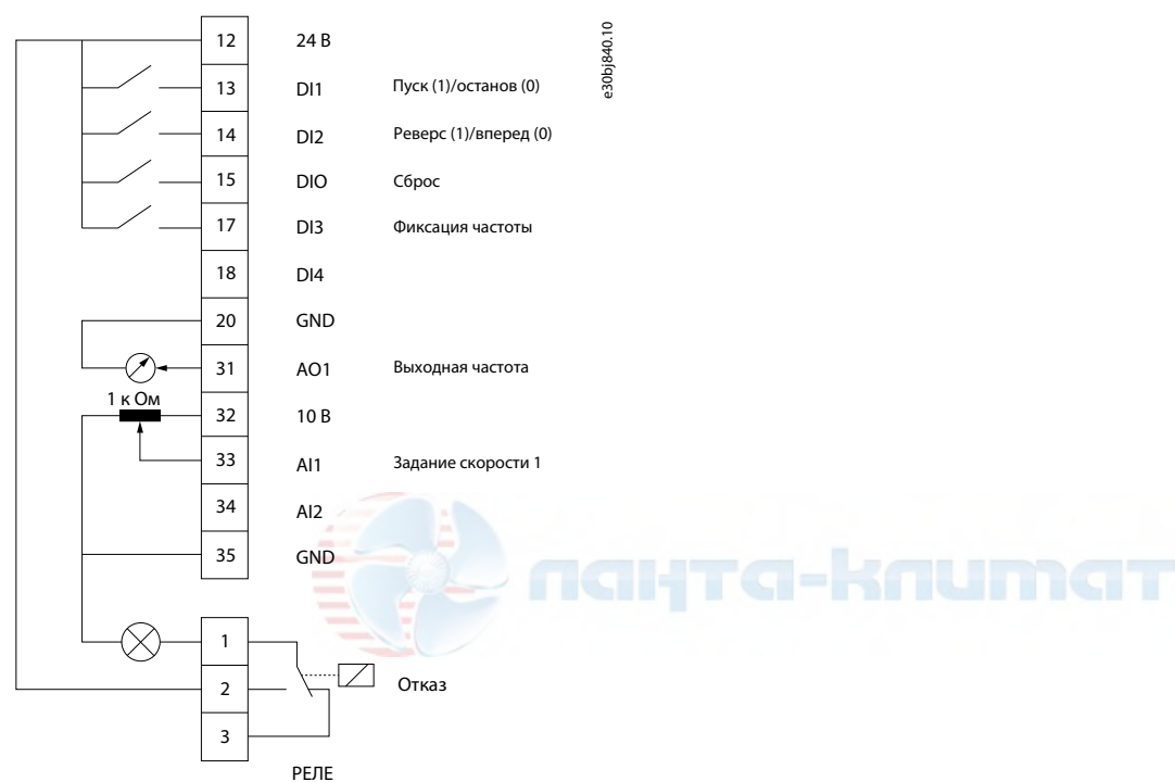
Рисунок 24: Цепи управления, используемые по умолчанию
