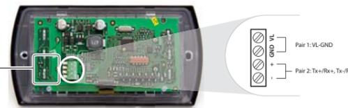
7. В завершение работы закрепите pGD на тыльной части корпуса, удерживая проводники загнутыми только с правой стороны (вид спереди)
