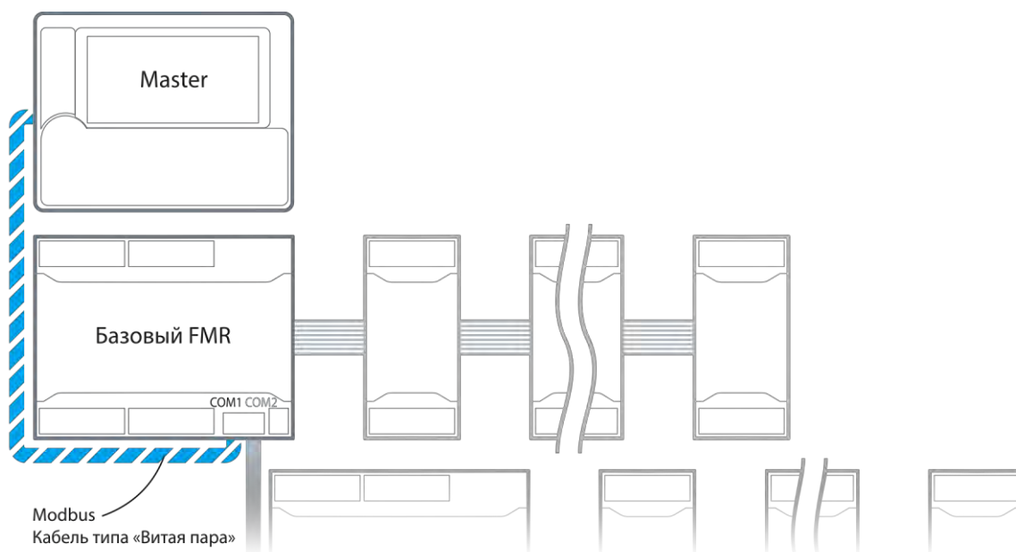
Рис. 26 - Подключение модуля FMR к контроллеру
