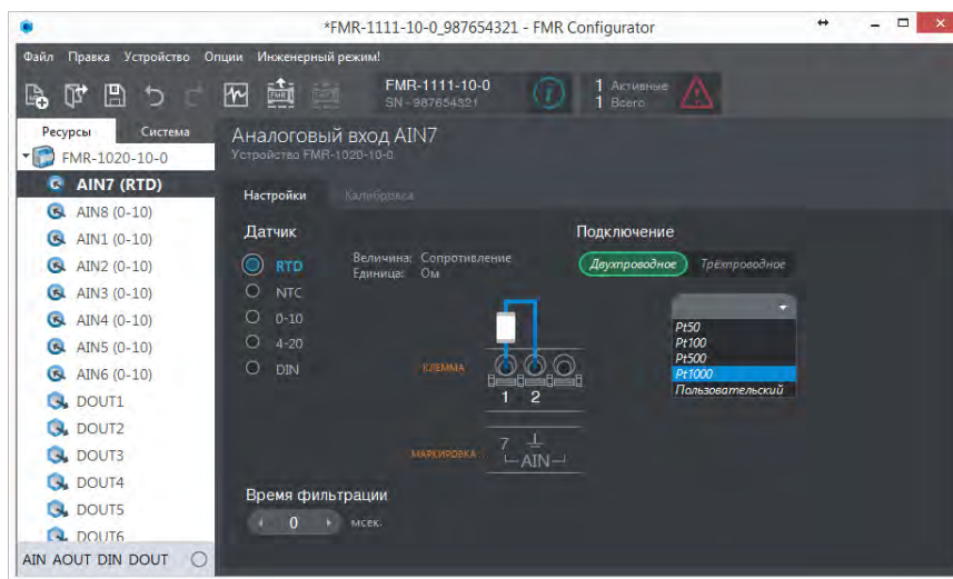
Рис. 35 - Настройка датчика RTD
