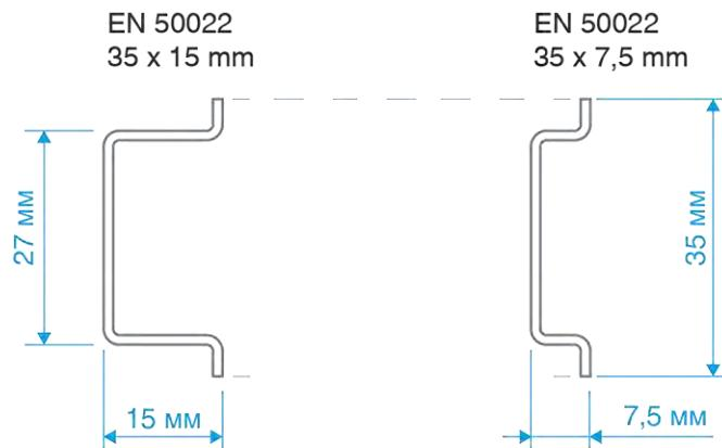
Рис. 46 -Варианты DIN-рейек для монтажа
