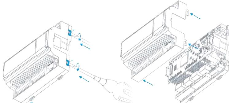
Рис. 62 –Разборка корпуса
