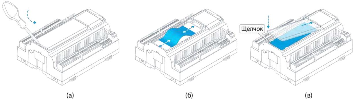
Рис. 4 – Извлечение и установка маркировочного вкладыша
