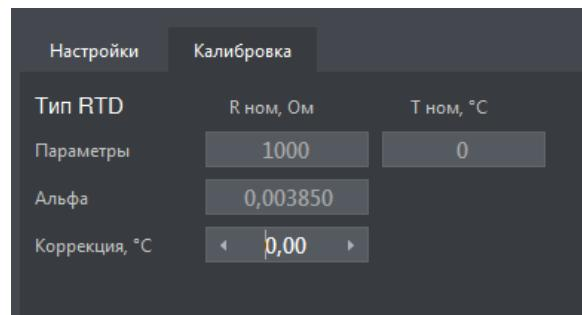
Рис. 56 –Калибровка температурных датчиков
