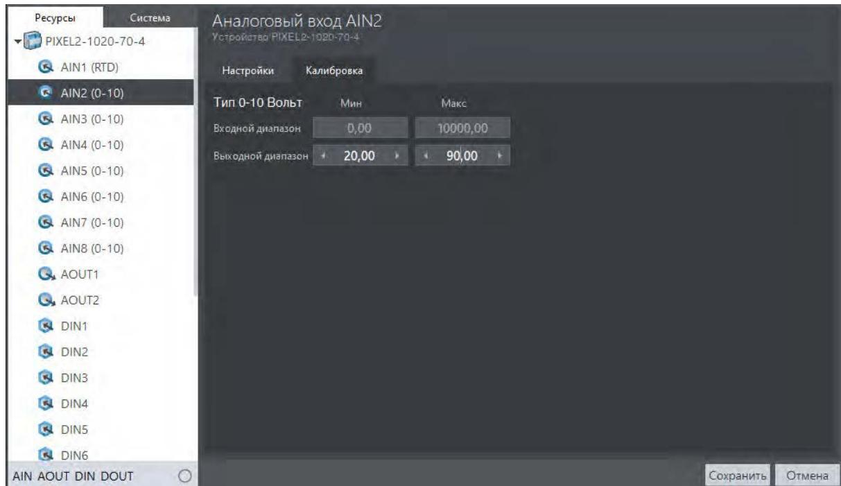
Рис. 57 –Настстройка масштабирования измеренной величины
