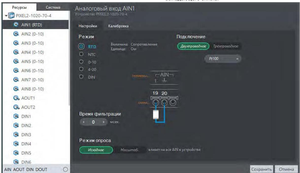
Рис. 55 –Настройка датчика RTD
