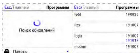
Рис. 35 - Экран поиска и просмотра обновлений
