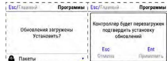
Рис. 37 - Экран запроса и подтверждения установки обновлений
