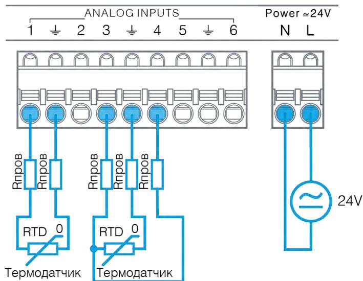
Рис. 19 - Двухпроводное и трёхпроводное подключение резистивных датчиков.
