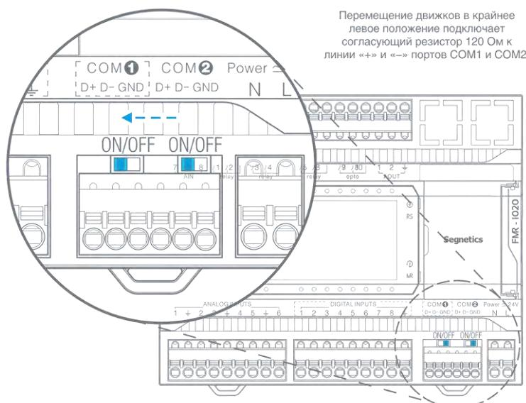
Рис. 22 - Включение терминалора интерфейса RS-485
