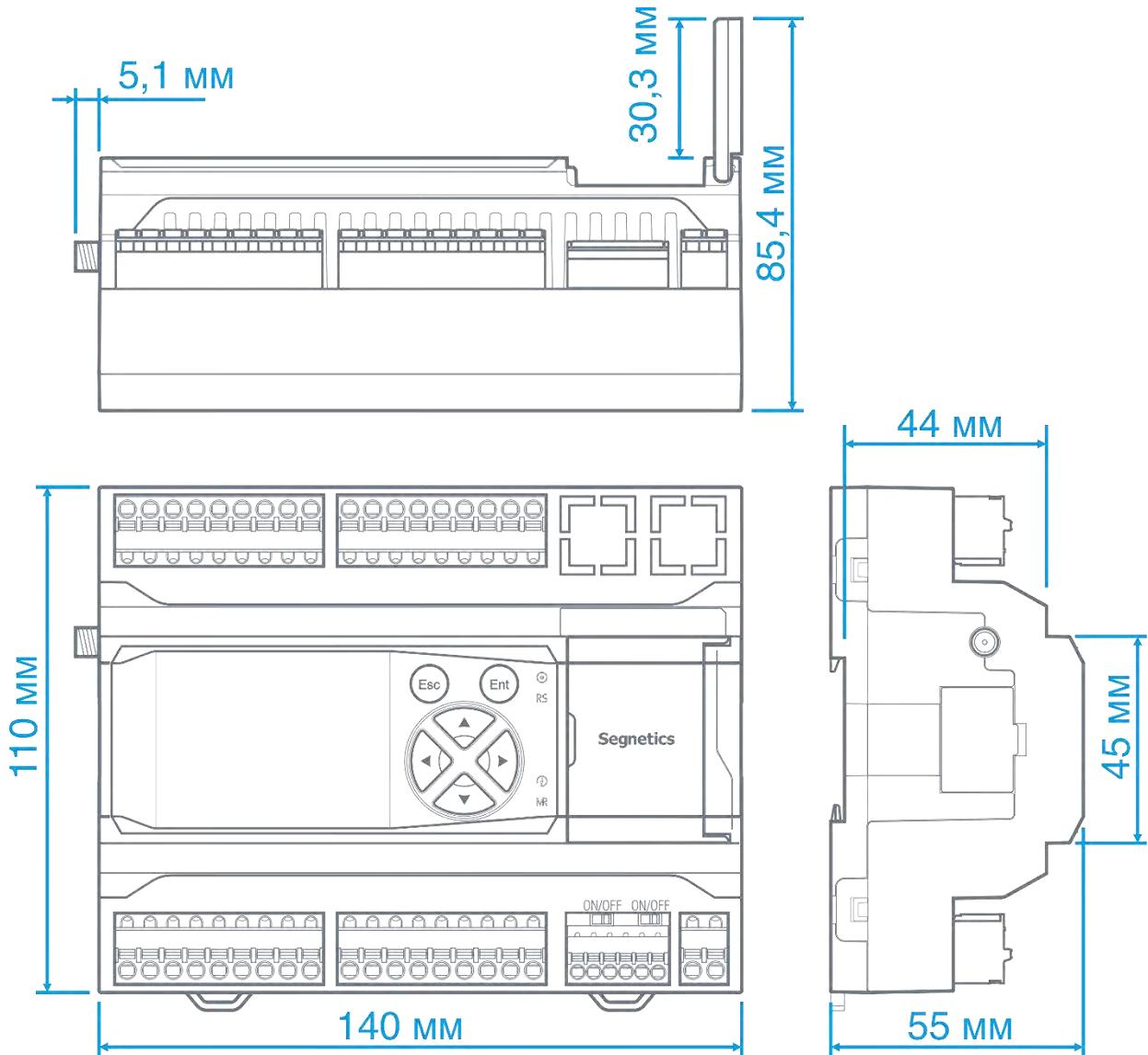
Рис. 48 - Габаритные и установочные размеры контроллера
