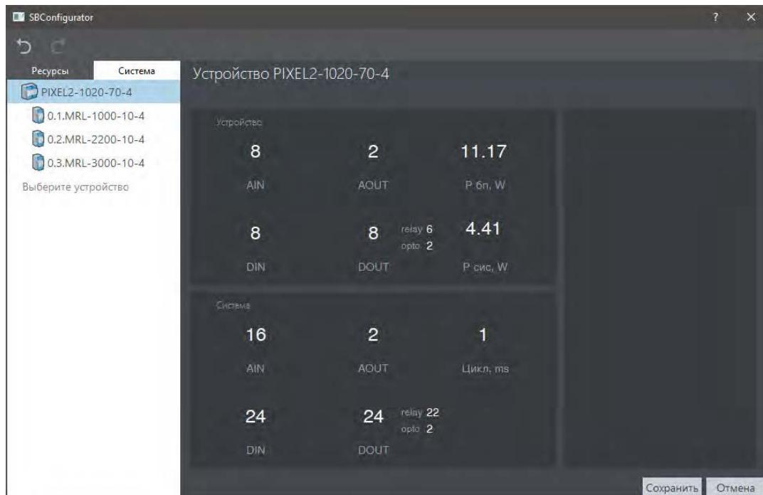
Рис. 51 –Конфигуратор системной шины
