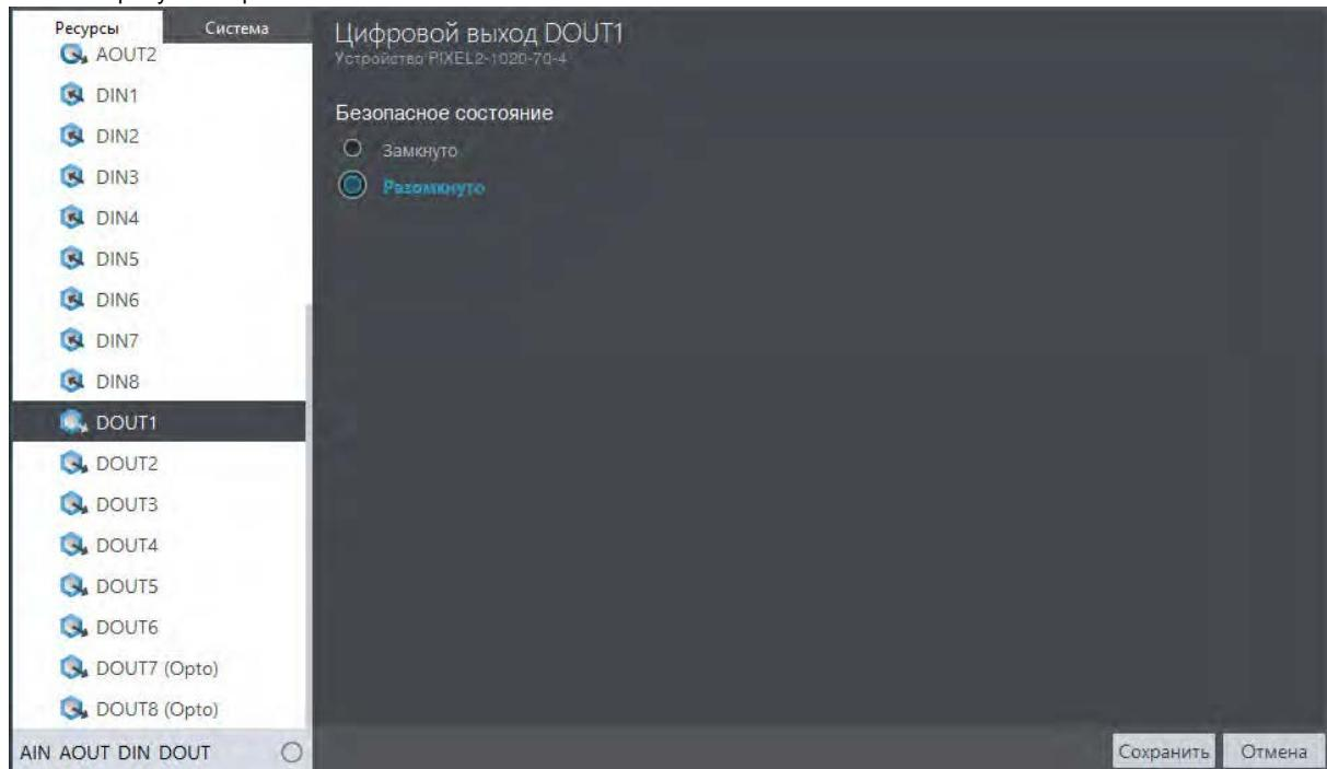
Рис. 59 – Конфигурирование DOUT
