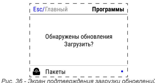
Рис. 36 - Экран подтверждения загрузки обновлений
