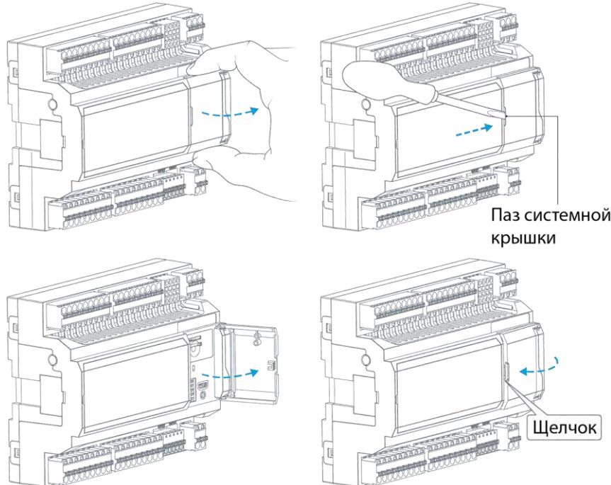
Рис. 9 – Открывание и закрывание крышки системного отсека
