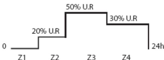
Установка временного диапазона «суточный» и «переменная уставка» позволяет задать производительность по распылению воды отвечающую потребностям помещения.
